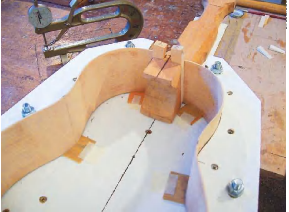
► Pic.29 The heel wedges in place
